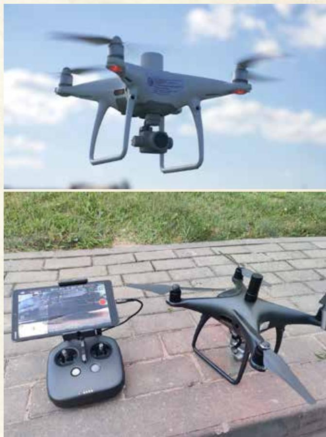
Рисунок 2 – DJI Phantom 4 RTK (сверху) и DJI Phantom 4 Теодрон PPK AGNSS L1/L2 (снизу)
