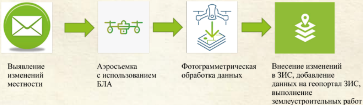
Рисунок 3 – Схема использования малых БЛА для мониторинга земель
