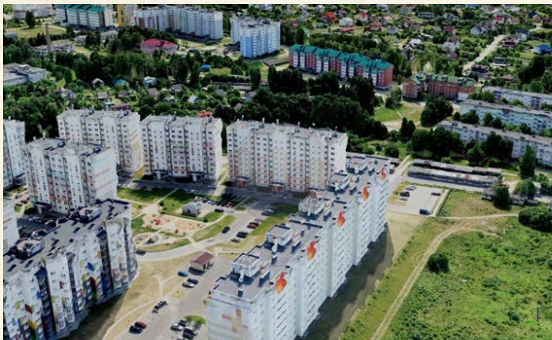
Рисунок 2 – Фрагмент тайловой модели местности, полученный по материалам аэрофотосъемки с использованием БПЛА Геоскан 201
