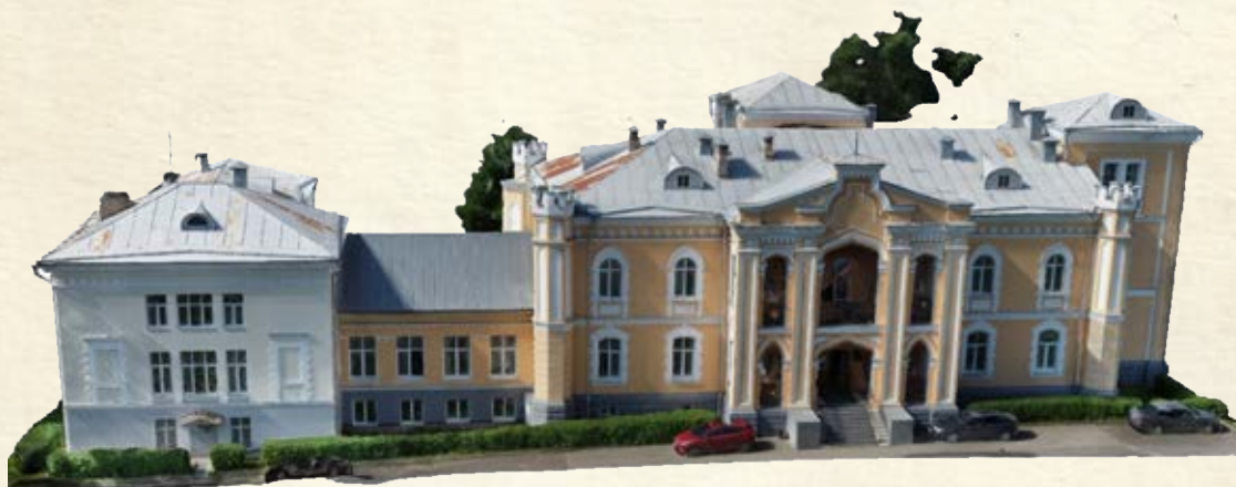
Рисунок 7 – Трехмерная модель, полученная по материалам аэрофотосъемки с использованием квадрокоптеров DJI Phantom 4 Pro v2.0 и DJI Mini 2
