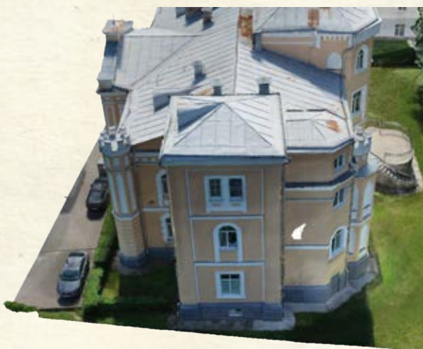
Рисунок 8 – Фрагменты трехмерной модели, полученные с использованием: а) только материалов аэрофотосъемки; б) материалов воздушной и наземной съемки (комбинированный метод)
