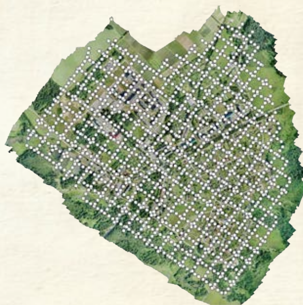
Рисунок 1 – Положение центров фотографирования во время аэрофотосъемочного процесса с использованием БПЛА Геоскан 201
