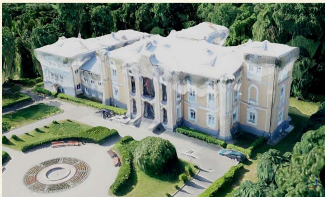
Рисунок 6 – Фрагмент трехмерного изображения на территорию дворцово-паркового комплекса Чапских в аг. Прилуки, полученный путем экспорта из первоначальной тайловой модели
